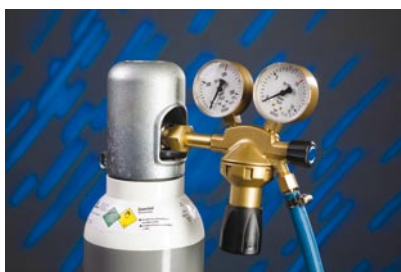
Afb. 1 Reduceertoestel op een gascilinder (goed)
