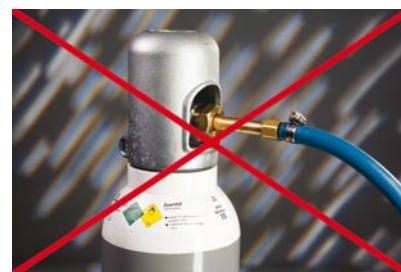
Afb. 2 Gascilinder zonder reduceertoestel (fout)
